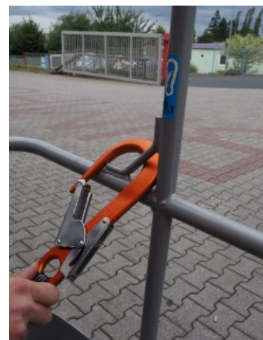
Abb. 4: Kennzeichnung mit zugelassenen Personenzahl am Anschlagpunkt der Hubarbeitsbühne
