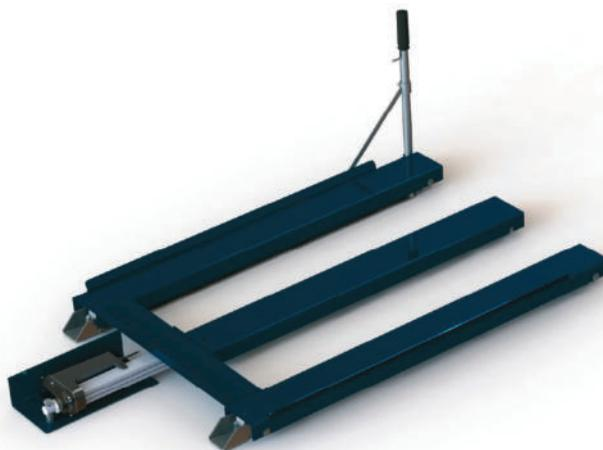
Dieser Bodenauszug wird durch einen E-Motor angetrieben, der hinter dem Bodenauszug sitzt. Aufgrund der hohen Traglasten der Ladungsträger und des häufigen Hervorziehens wünschte sich der Kunde eine elektrische Unterstützung.
