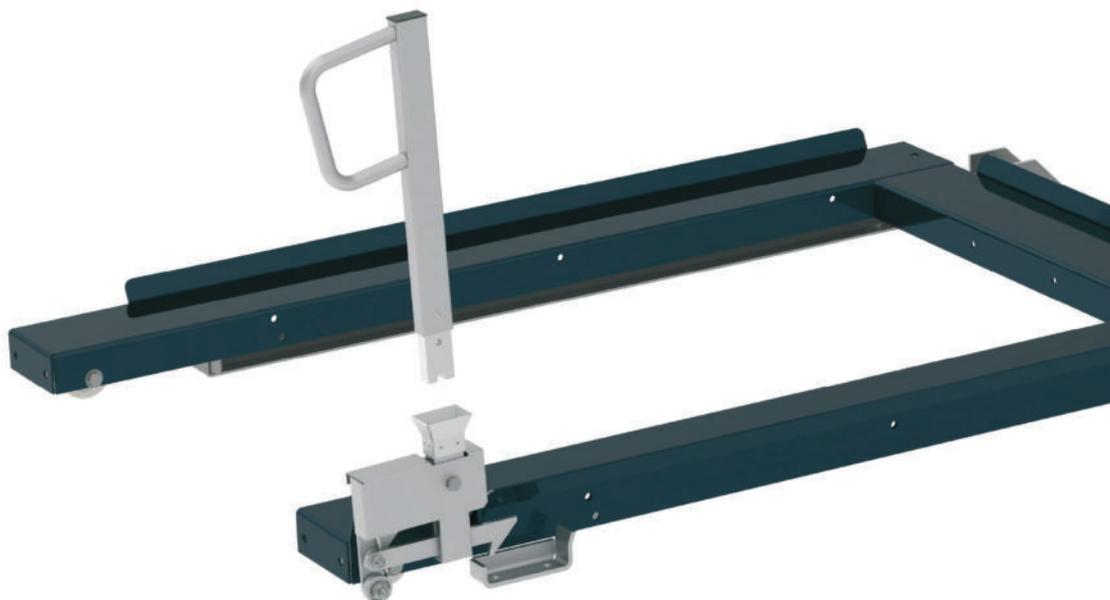
Beim Beladen der Bodenauszüge mit einer Ameise oder einem Stapler erfordert der Ziehgriff ein sehr genaues Manövrieren, damit der Griff nicht beschädigt wird. Deshalb kann bei diesem Bodenauszug der Easy-Action-Griff einfach abgenommen werden, wenn der Auszug beladen wird. Nach der Beladung wird er wieder in die Griffhalterung gesteckt und der Auszug kann weiter benutzt werden.
